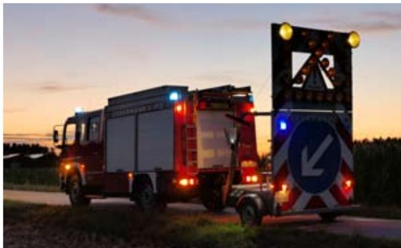
Der Verkehrssicherungsanhänger ist ein einachsiger Anhänger der Firma Trebbiner Fahrzeugbau mit einem zulässigen Gesamtgewicht von 750 kg. Der Aufbau der Lichtanlage kommt von der Firma Horizont. Als Zugfahrzeug wird das LF 8/6 eingesetzt. Dafür wurde eine Fernbedienung ins Fahrerhaus gelegt, um von dort aus die Bedienung der Tafel während der Anfahrt vorzunehmen. Dadurch kann beispielsweise der noch fließende Verkehr vor einer Unfallstelle verzögert oder auf andere Fahrspuren umgeleitet werden.
