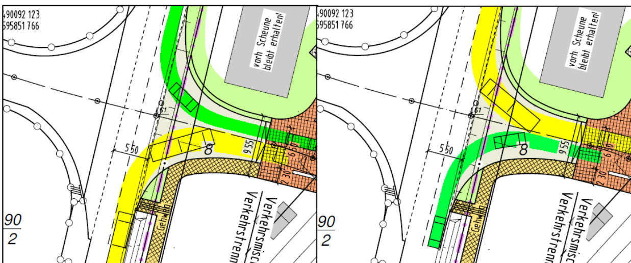
Abb. 7 und 8: Schleppkurven Begegnungsfall Pkw/3-achsiges Müllfahrzeug (Einmündungsbereich Baugebiet)
