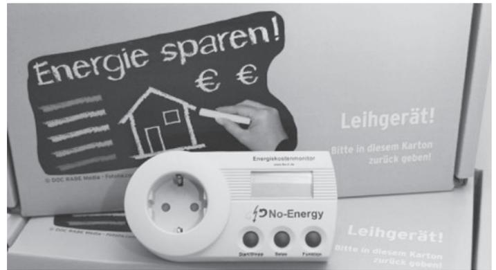
an und deckt so heimliche Stromfresser auf. Die Energiekosten eines Gerätes erhalten Sie, indem Sie den Strompreis pro kWh in das Messgerät eingeben.
