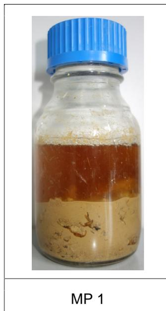
Bei der Mischproben MP 1 der Geschiebelehmen wurde eine leichte bis mittlere Verfärbung festgestellt. Somit weisen die Geschiebelehmen einen geringen Anteil von Huminsäuren auf. Soll eine Bodenstabilisierung der Geschiebelehmen mit Bindemittel erfolgen, muss vorab eine Eignungsprüfung bzw. eine Probestabilisierung ausgeführt werden. Erfahrungsgemäß kann davon ausgegangen wer-
