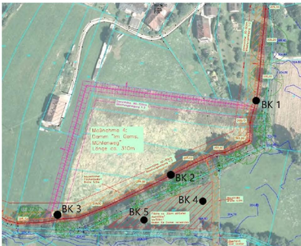
Abb. 7: Lage der Kleinrammkernbohrungen
