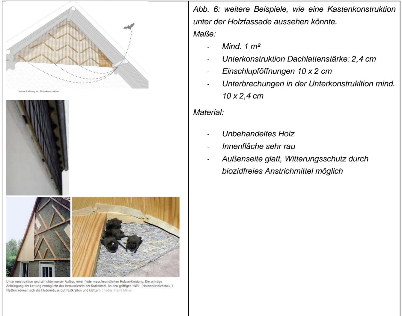
Abb. 6: weitere Beispiele, wie eine Kastenkonstruktion unter der Holzfassade aussehen könnte.
